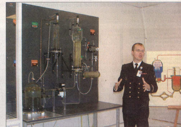
Cette maquette en verre permet de comprendre le principe d'un réacteur nucléaire.
