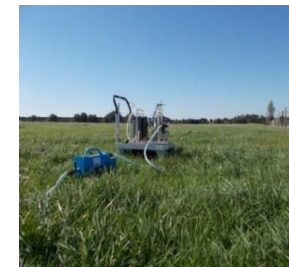
Emission et dépôt de particules de fluorescéine (Herbe synthétique au niveau du sol et filtres 20 cm au-dessus du couvert)
