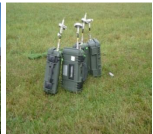
Emission et dépôt de particules de fluorescéine (Herbe synthétique au niveau du sol et filtres 20 cm au-dessus du couvert)
