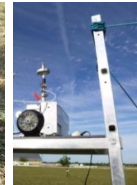
Méthode du gradient de la fraction libre des descendants du ^{222}\text{Rn} (50 cm et 2 m)
