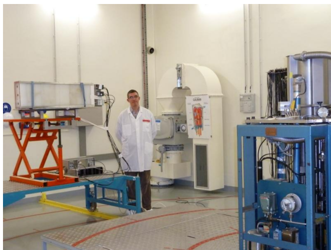
Le dispositif expérimental. On aperçoit au premier plan le réacteur Caliban, et à l'arrière plan l'ensemble de détection.
