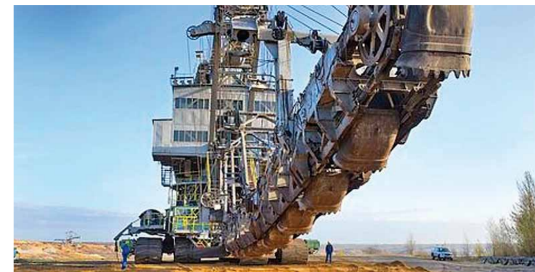
6) Excavatrice déblayant le mort-terrain situé au-dessus du lignite
